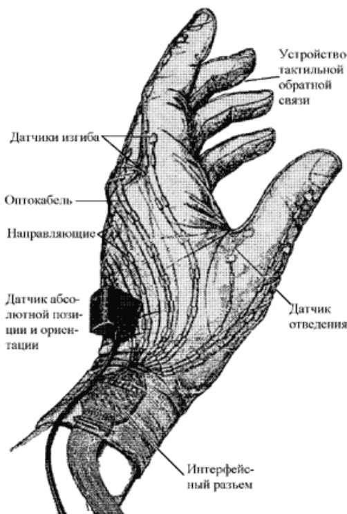
Рис.3 Перчатка данных фирмы VPL
